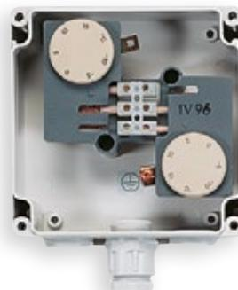
Double thermostat bimétallique pour une régulation simple des chauffages de gouttières en fonction de la température, 2 points de température réglables. Convient uniquement aux petites installations ; pour les installations plus importantes, nous vous recommandons d'utiliser une commande en fonction de la température et de l'humidité.
